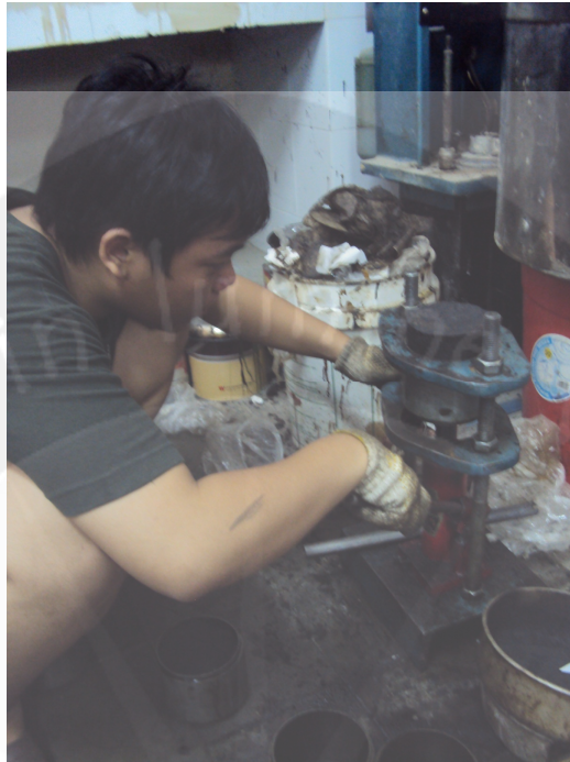
Pengeluaran Briket Aspal dari Dalam Mold
