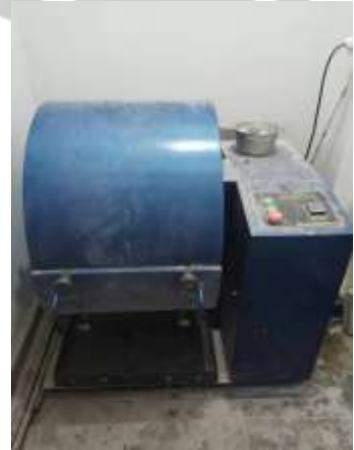
Pengujian Keausan Agregat Kasar
