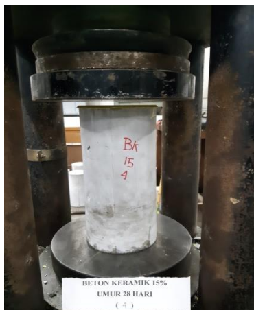
Pengujian Kuat Tekan Beton
