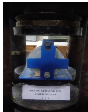
Pengujian Kuat Tarik Belah Beton
