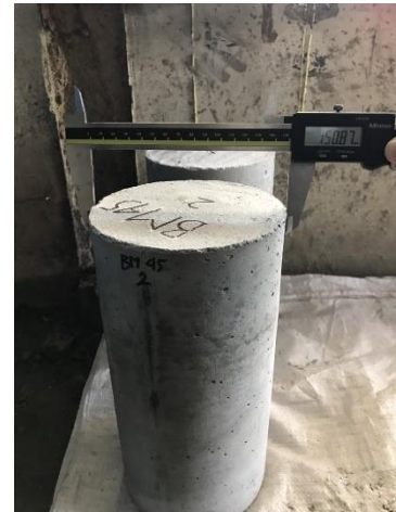
Pengukuran Dimensi Silinder Beton
