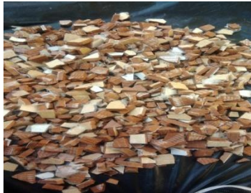
Keramik Setelah Waterproofing Treatment
