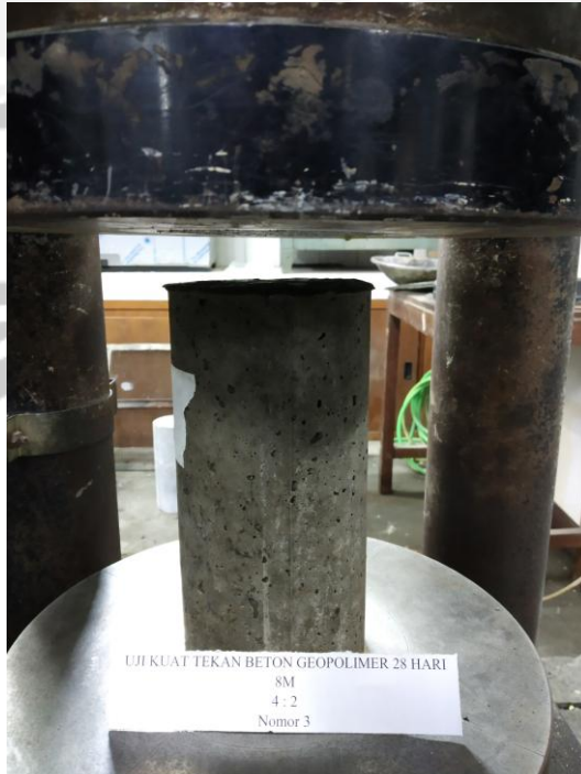
Pengujian kuat tekan beton geopolimer
