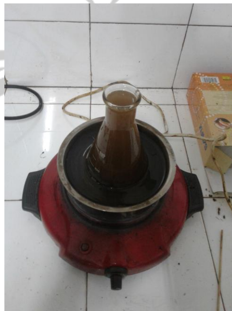
Pengujian berat jenis agregat halus terak baja
