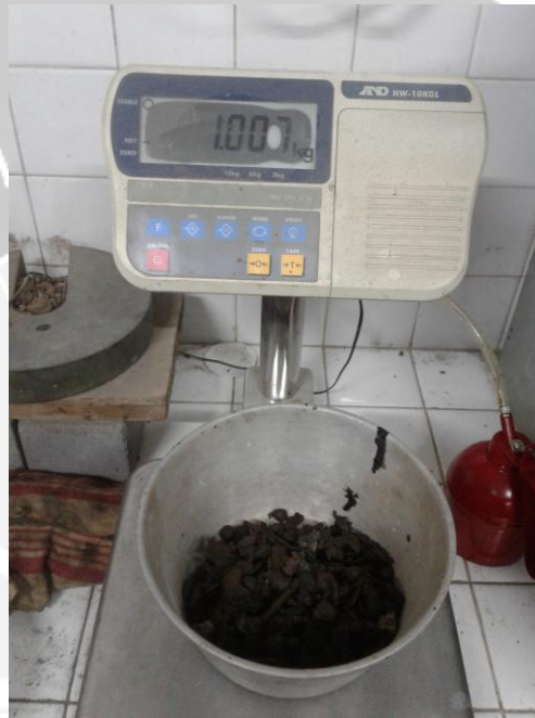
Pengujian berat jenis agregat kasar terak baja
