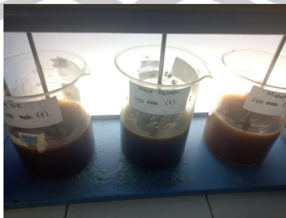
Jar test limbah logam krom yang telah diberikan serbuk mahoni, sabut kelapa, dan campuran serbuk mahoni dan kelapa
