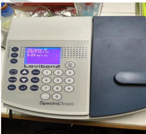
q. Pengukuran Cu dengan Spektrofotometer
