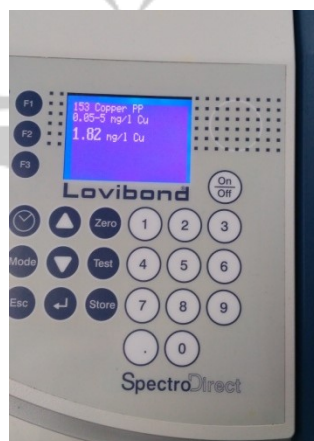
Gambar 52. Kenampakan kadar Cu pada layar spektrofotometer
