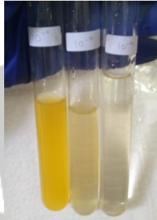
Gambar 47. Pengenceran sampel limbah sebelum penambahan tablet Cu-LR
