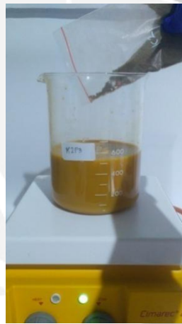
Gambar 48. Koagulasi Limbah PCB dengan kitosan
