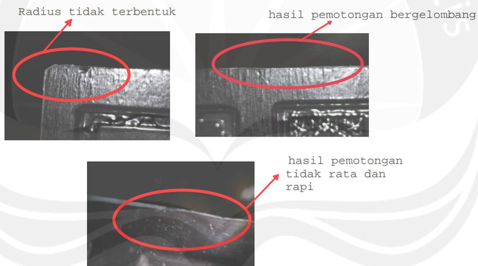
Gambar 1.1. Sampel hasil pemotongan sekarang
