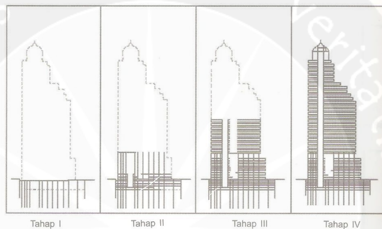
Gambar 2. 15. Tahap pelaksanaan dengan metode Up-Down Construction Sumber : Sistem Bangunan Tinggi, Ir. Jimmy S. Juwana, MSAE
