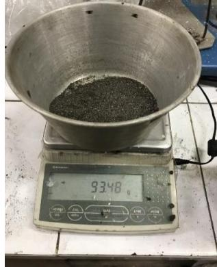
Pengujian Kadar Lumpur Pasir
