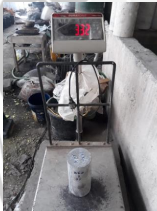
Penimbangan Berat Beton
