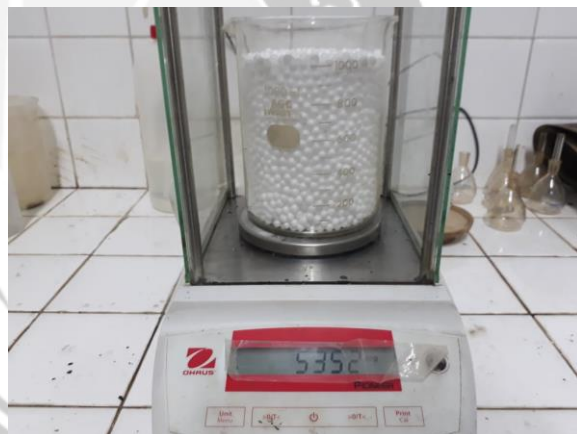
Pengujian Berat Isi Styrofoam
