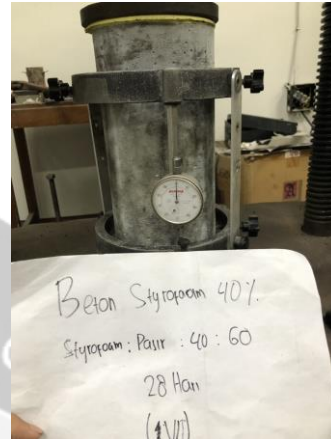
Pengujian Modulus Elastisitas
