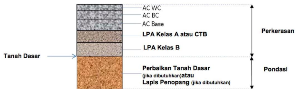
Gambar 2.1. Struktur Perkerasan Lentur pada Permukaan Tanah Asli
