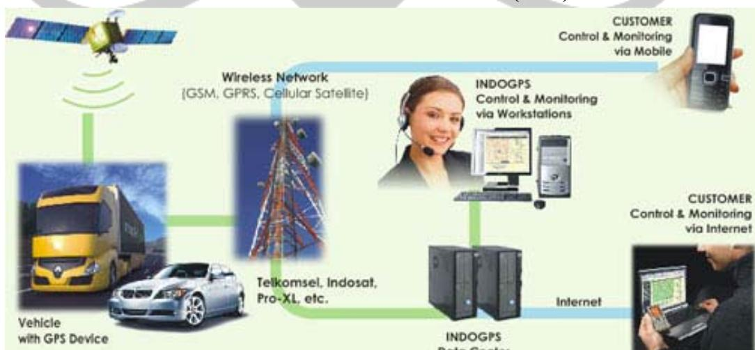
Keterangan: Skema mekanisme Global Positioning System(GPS) yang di gunakan Koran Jakarta untuk melakukan control dan monitoring terhadap kendaraan distribusinya. Detector GPS dipasang di dalam mobil dan memancarkan sinyal GPRS secara simultan ke satelit, sehingga dapat diketahui pergerakannya oleh bagian controlling Koran Jakarta
