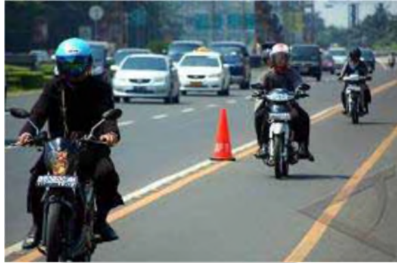
Gambar 2.1 Lajur Sepeda Motor Inklusif di Jakarta Sedangkan penerapan lajur khusus sepeda motor di jalan menuju Bandara Soekarno Hatta, Tangerang menggunakan pemisah berupa traffic cone dan marka seperti pada gambar 2.2.
