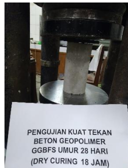
Pengujian Kuat Tekan Beton
