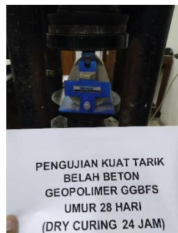
Pengujian Kuat Tarik Belah Beton
