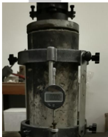
Gambar 4.4 Pengujian Modulus Elastisitas Beton
