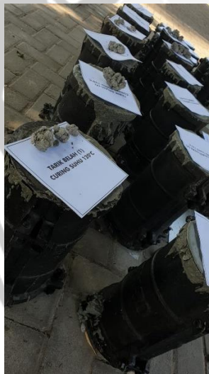
Adonan Beton Dalam Cetakan
