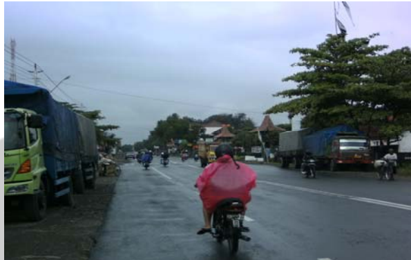
Gambar 1.9. Kendaraan parkir yang menyebabkan hambatan samping
