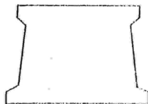
masif dari beton bertulang
