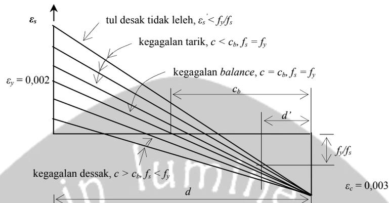
Gambar 2.2. Diagram Regangan untuk Kegagalan Eksentrisitas Beban Kolom
