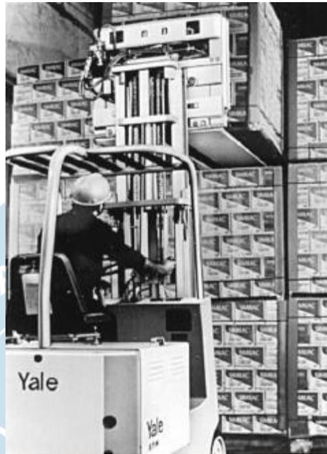
**Gambar 2.1 Penerapan *Block Stacking***
