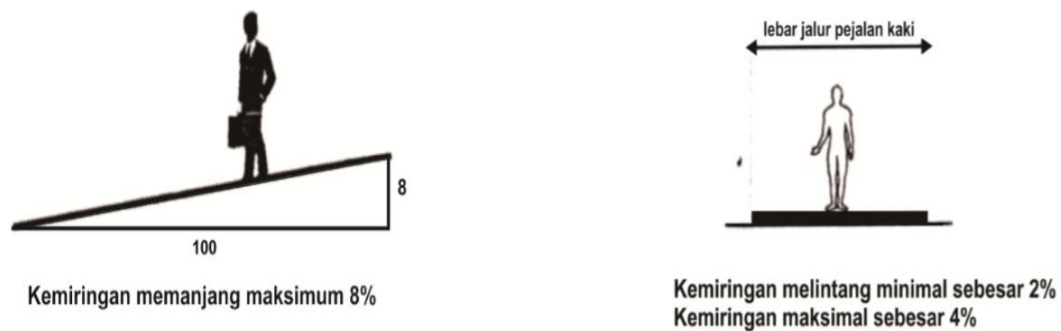
Gambar 3.6 Kemiringan Jalur Pejalan Kaki (Sumber: Peraturan Menteri PU No. 3 Tahun 2014)
