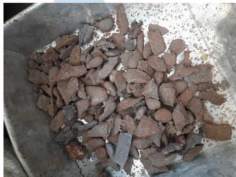
Gambar 3.5 *Steel Slag* Sebagai Bahan Substitusi
