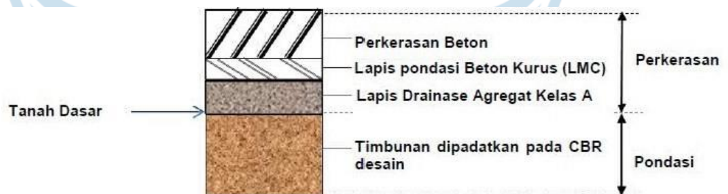
Struktur Perkerasan Kaku pada Permukaan Tanah Tibunan
