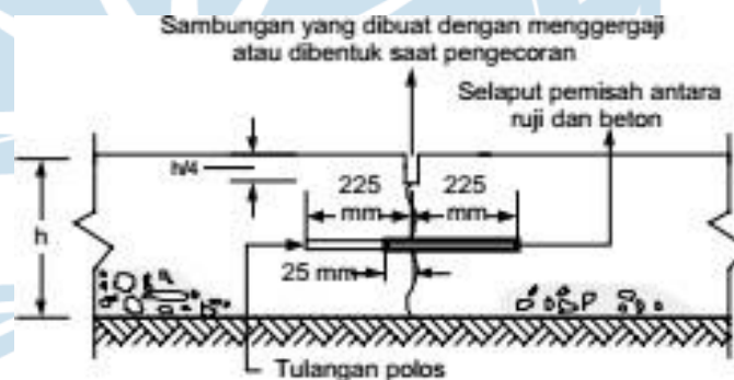
Gambar 3. 3 Sambungan Susut Melintang dengan Ruji
