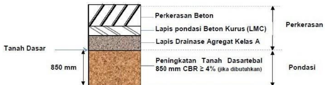
Struktur Perkerasan Kaku pada Permukaan Tanah Galian
