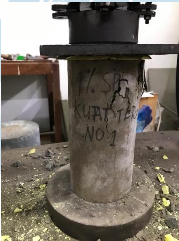
Pengujian Kuat Tekan Beton
