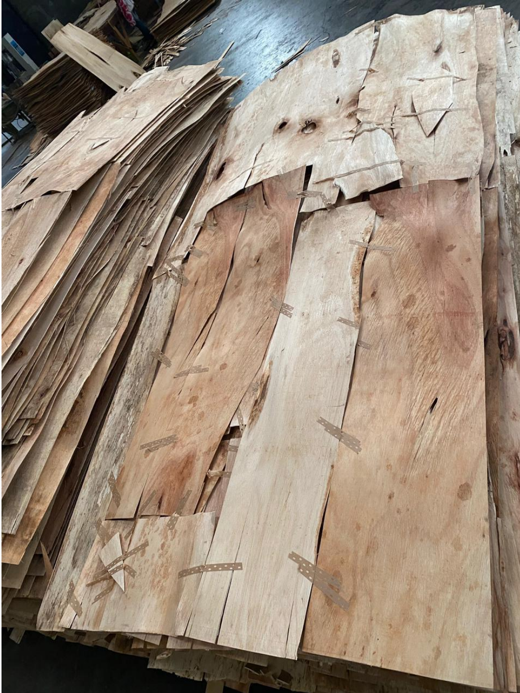
Lampiran 9. Veneer dengan Kerusakan Parah di Departemen Repair Core
