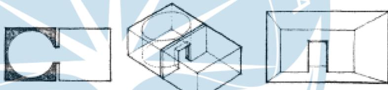
**Gambar 3.19. Dinding Pembatas dengan Akses Tunggal**
