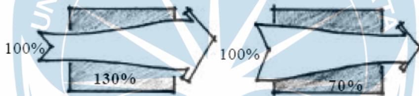
Dimensi jendela yang berbeda antara inlet dan outlet
