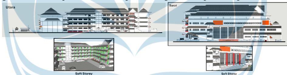
Gambar 5.8 Soft storey pada tampak bangunan
