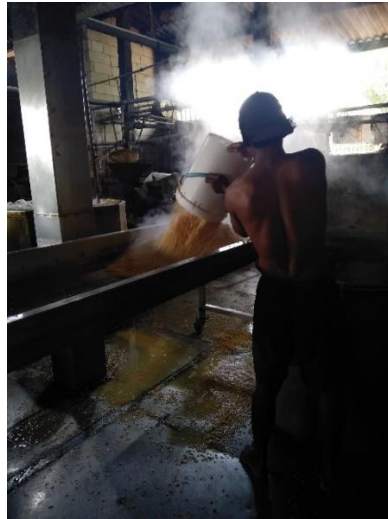
Gambar 3.23. Pemindahan Kedelai untuk Didinginkan
