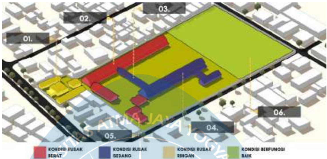
Gambar 2. 4 Kondisi Fisik Bangunan Berdasarkan Observasi Sumber: Penulis
