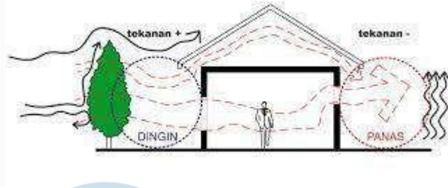
Gambar 2.14 Gambaran sistem penghawaan alami
