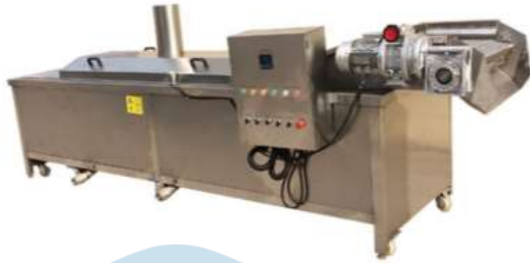
Gambar 2.27 : Mesin Blancher (Wulan, 2016)
