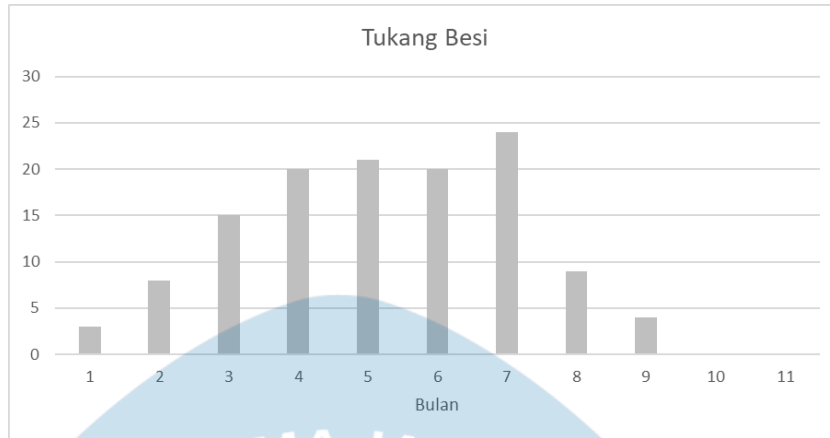
Gambar 4.5 Sumber daya Tukang Besi Sebelum Resources levelling
