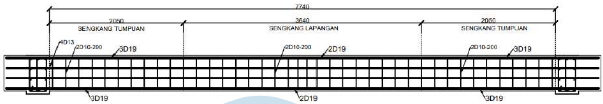
Gambar 2.57 Gambar Penampang Melintang Balok Anak BA 2 300x550 mm
