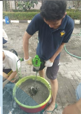
Proses Pengadukan Beton Geopolimer
