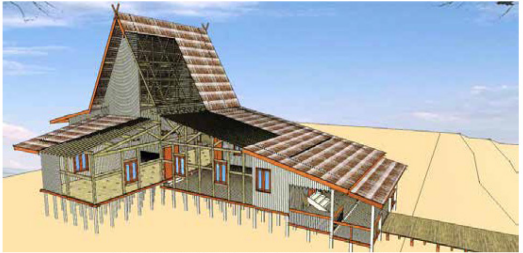
Gambar 1.15. Konstruksi Rumah Bubungan Tinggi Bajar (Ilustrasi: Karyadi, Achmad)
