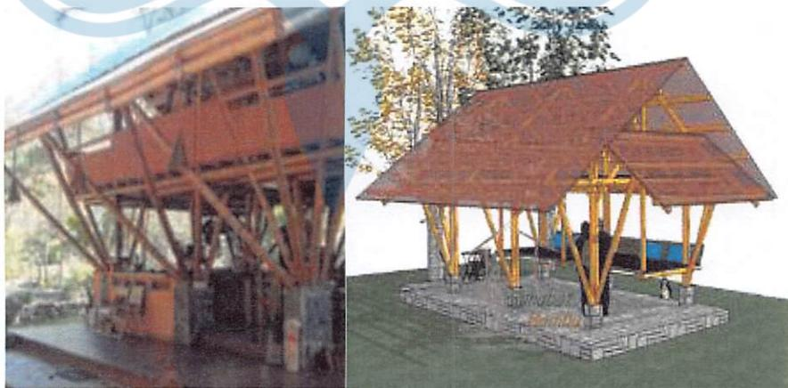
Gambar 6.11 : Ekspolrasi bentuk kolom dari bambu
