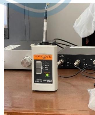
Namun pada gambar diatas merupakan mikrofon yang sudah dikalibrasi, akan lebih meningkatnya akurasi sensitivasi mikrofon saat digunakan pengukuran, pengurangan ketidakpastian hal ini mendapatkan hasil pengukuran yang lebih konsisten, komptibilitas dengan tabung
