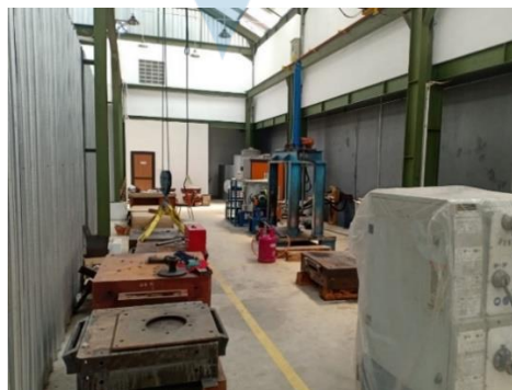
Gambar 3.8. Cetakan Cor Menghalangi Aliran Material serta Area Burner , Area Burner , Area Pengelasan, dan Area Pelubangan Belum Definitif
