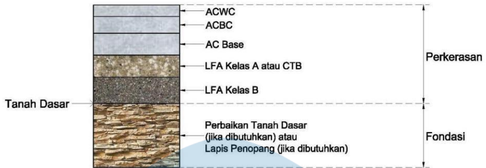
Gambar 2.12 Struktur Perkerasan Lentur ( Flexible Pavement )
