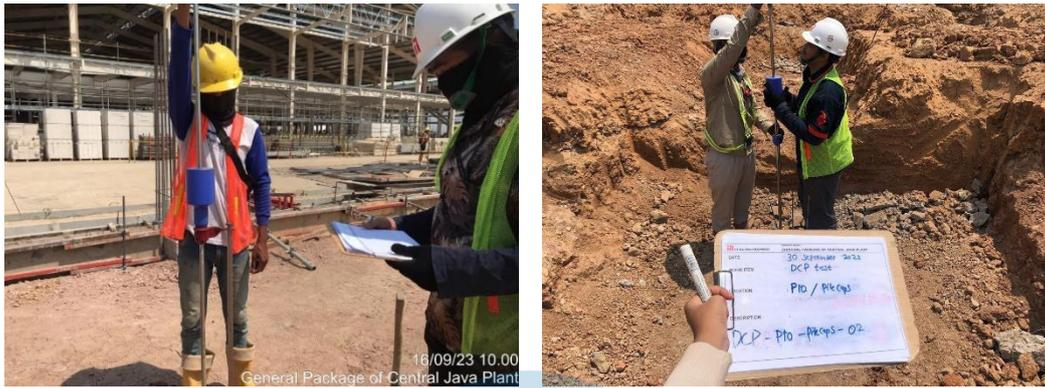
Gambar 2.13 Pelaksanaan pengetesan tanah dengan dynamic cone penetrometer (DCP)
