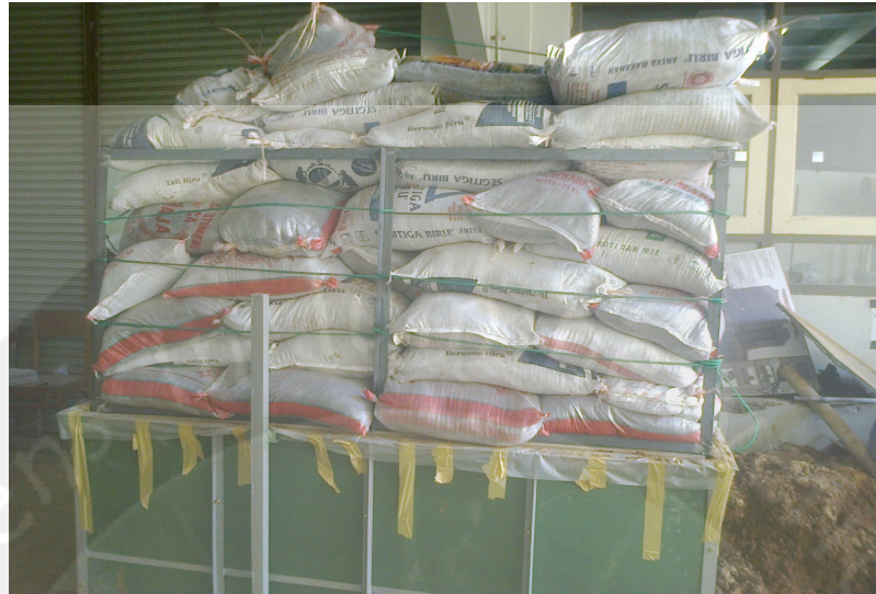
Gambar L.3 Beban Pre-loading Seberat 4 Ton
