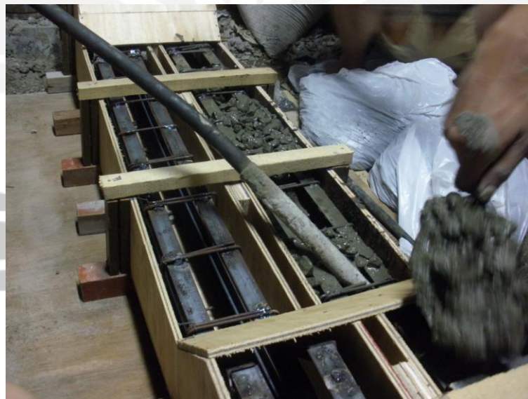
Gambar 5. Pengecoran Benda Uji
