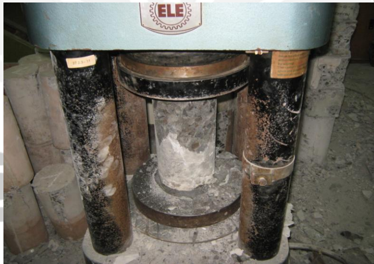
Gambar 10. Pengujian Kuat Desak Beton
