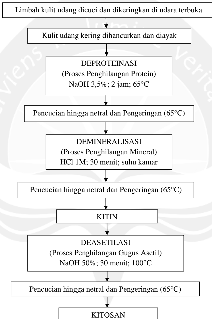
Gambar 13. Proses Pembuatan Kitosan Sumber: Mahatmanti (2001)
