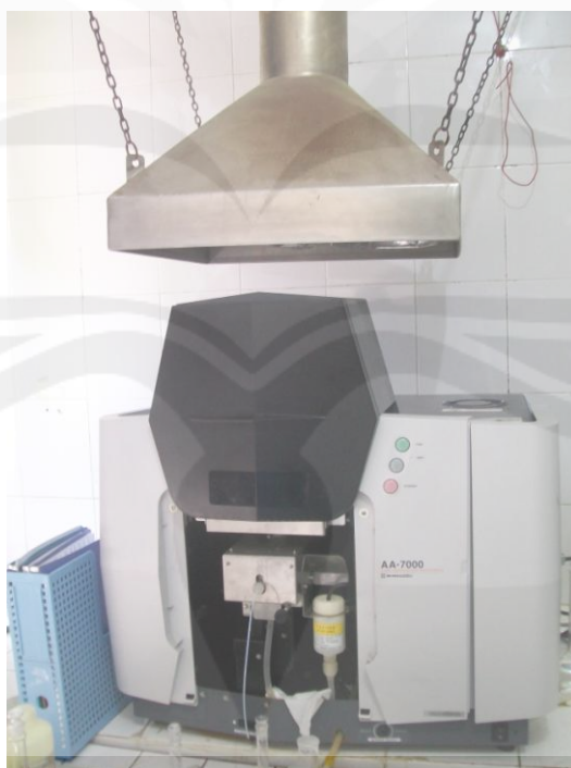
Gambar 10. Alat AAS ( Atomic Absorption Spechtrofotometer )
