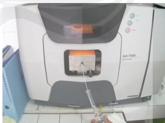
Gambar 28. Sampel diuji dengan AAS
