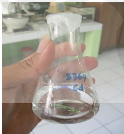
Gambar 15. Sampel air sungai ditutup dengan kertas parafilm
