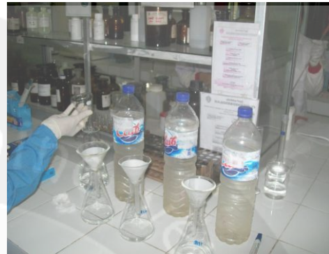
Gambar 12. Penyiapan tabung erlenmeyer dan kertas saring
