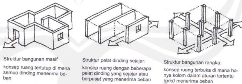
Gambar 2.9 Struktur masif, rangka, dan pelat dinding sejajar
