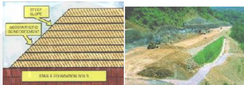
**Gambar 2.3 Fungsi Geotekstil Sebagai Stabilisator**
