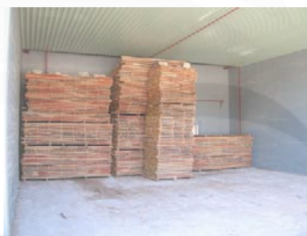
Gambar 2.2 Proses Pengeringan kayu
