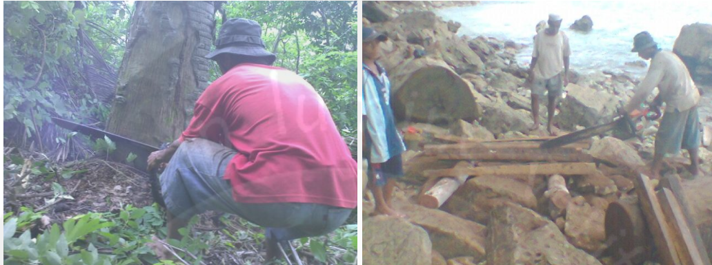
Gambar 1. Pembuatan Balok Kayu Lontar 90 x 90 x 1500 mm
