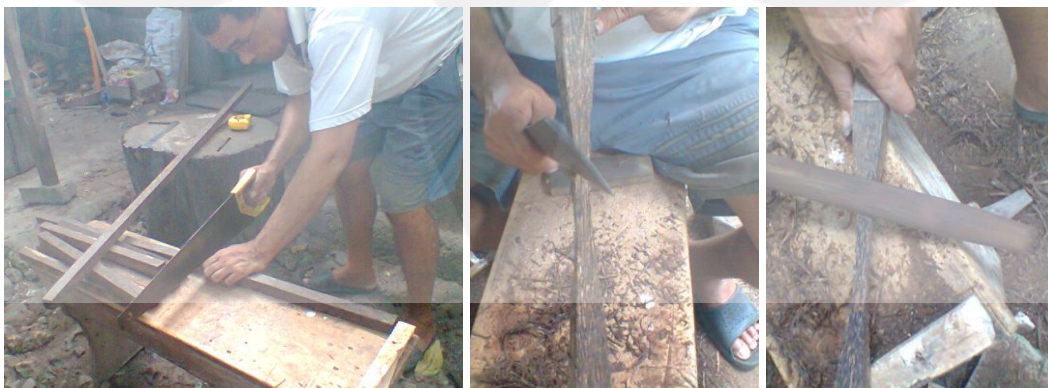
Gambar 3. Pembuatan Benda Uji Kuat Tarik Kayu Lontar Seजार Serat
