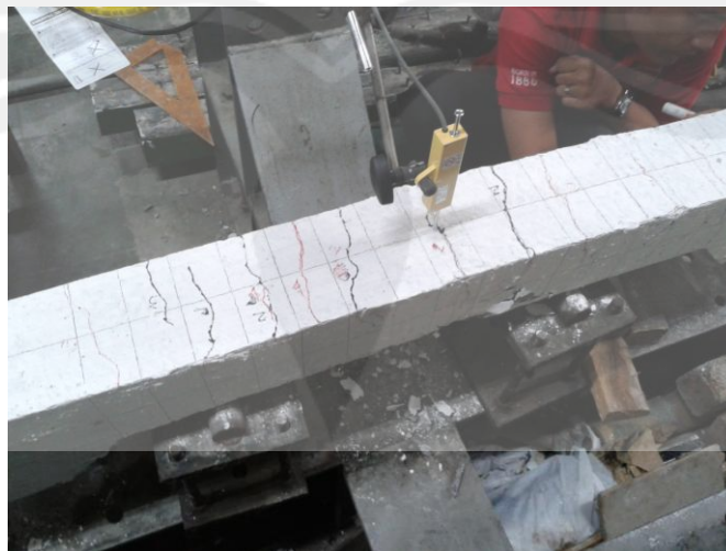
Gambar 9. Kolom saat Mencapai Beban Maksimum
