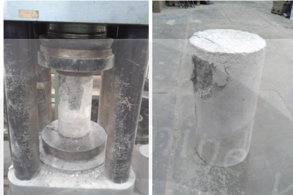
Gambar 7. Pengujian Kuat Tekan Silinder Beton
