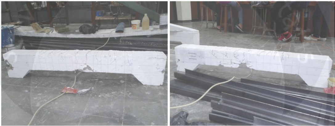
Gambar 11. Retakan pada Kolom dengan Variasi 8 Tulangan Kayu Lontar
