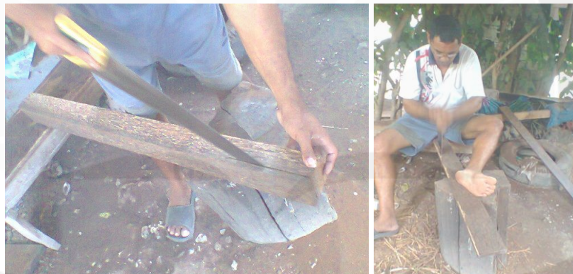
Gambar 2. Pembuatan Tulangan Kayu Lontar 12 x 12 x 1350 mm
